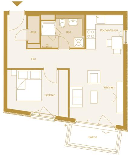
F = feststehendes Fensterelement // F = fixed window element
